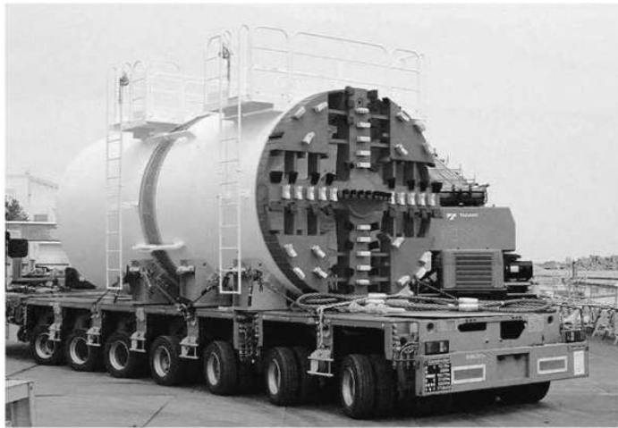
台車で運ばれるシールドマシン。25日に構内の立て坑底部に設置された＝東京電力福島第一原発で（東京電力提供）
